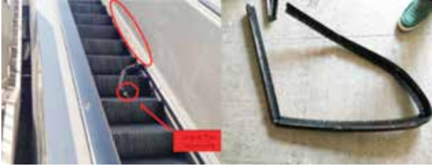
Resim 16- Metal Fırçadan Kaynaklı Meydana Gelen Kaza
